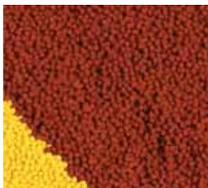
Компания «Дельтаколор» производит концентраты для окрашивания кабельной оболочки и изоляционного кабеля для внутреннего и наружного применений, производимых на основе ПЭ, сшитого ПЭ или ПП.
